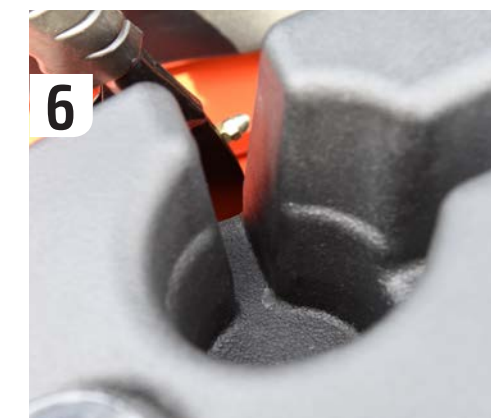
6 Een beker kun je gemakkelijk kwijt in de uitsparingen in de brandstoftank. Een gootje voert regenwater snel af.
