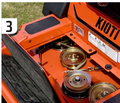
3 Door het met rubberbeklede platform op te klappen, wordt de aandrijving van het maaidek toegankelijk. Hier kun je de V-snaar spannen of vervangen.
