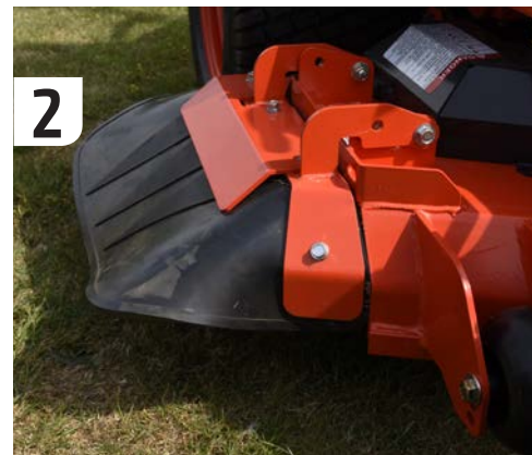
2 De zijuitworp is voorzien van een rubberflap. Kom je te dicht bij een boom of steen, dan geeft die flap mee. Schade rij je dus niet snel.
