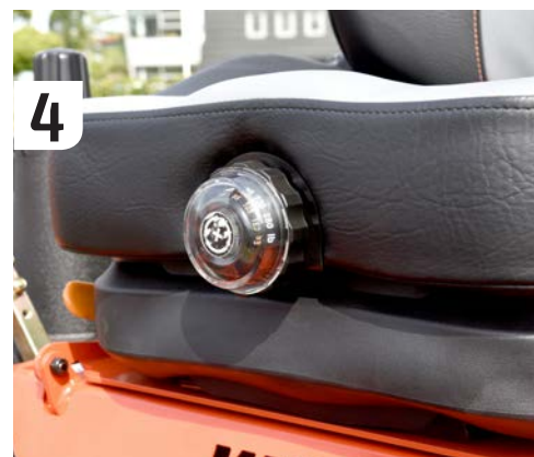
4 De ZXC heeft een geveerde en handmatig instelbare bestuurdersstoel. De ZXR moet het zonder die luxe doen. Daar is een niet-geveerde stoel standaard.
