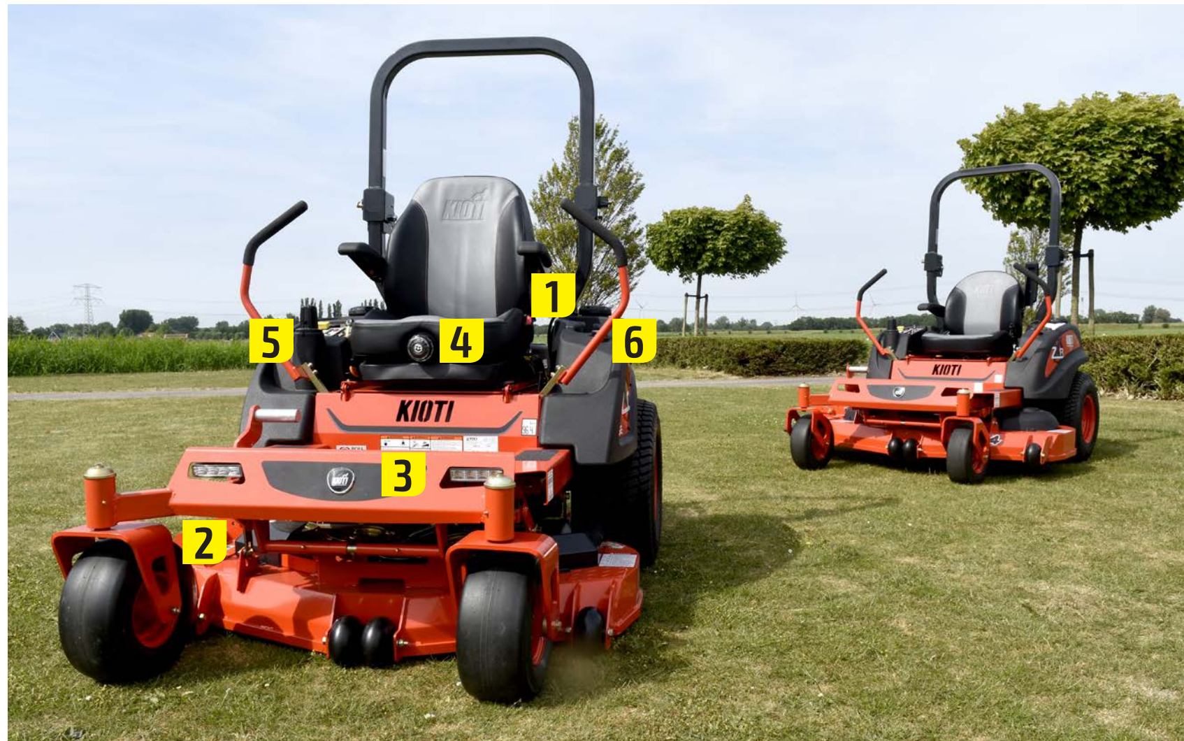
5 De machine heeft geen start sleutel maar een startknop. Daarnaast is er een lcd display dat informatie over de zeroturnmaaier weergeeft.
