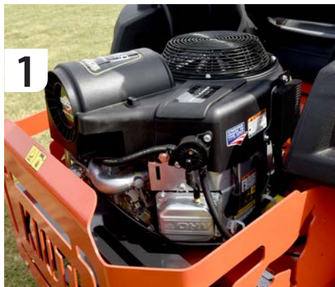
1 De ZXC48 EU wordt aangedreven door een Briggs & Stratton 17,15 kW benzine motor. Hij is nog voorzien van een carburateur maar start elektrisch.
