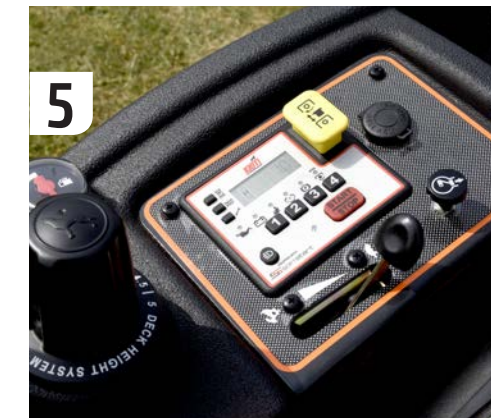
5 De machine heeft geen start sleutel maar een startknop. Daarnaast is er een lcd display dat informatie over de zeroturnmaaier weergeeft.
